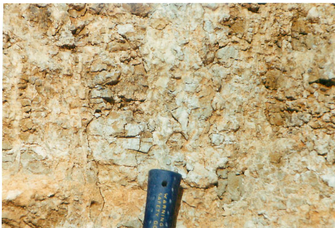
Figura 21.- Textura de los limos arenosos donde se aprecia el enrejado creado por la carbonatación vertical y horizontal.
